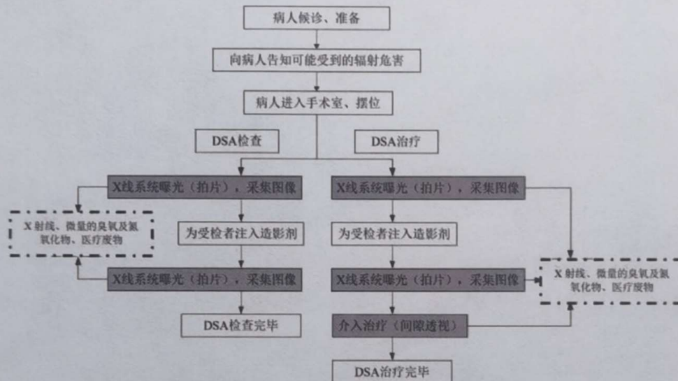
图2-2 医用血管造影X射线机工艺流程及产污图
